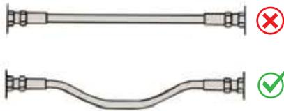
Es conveniente proporcionar el largo correcto para permitir la expansión y contracción. La manguera puede cambiar de longitud +2% a -4% bajo el incremento de la presión.
