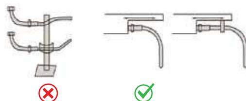
Evite que la manguera toque el objeto directamente para reducir la fricción.
